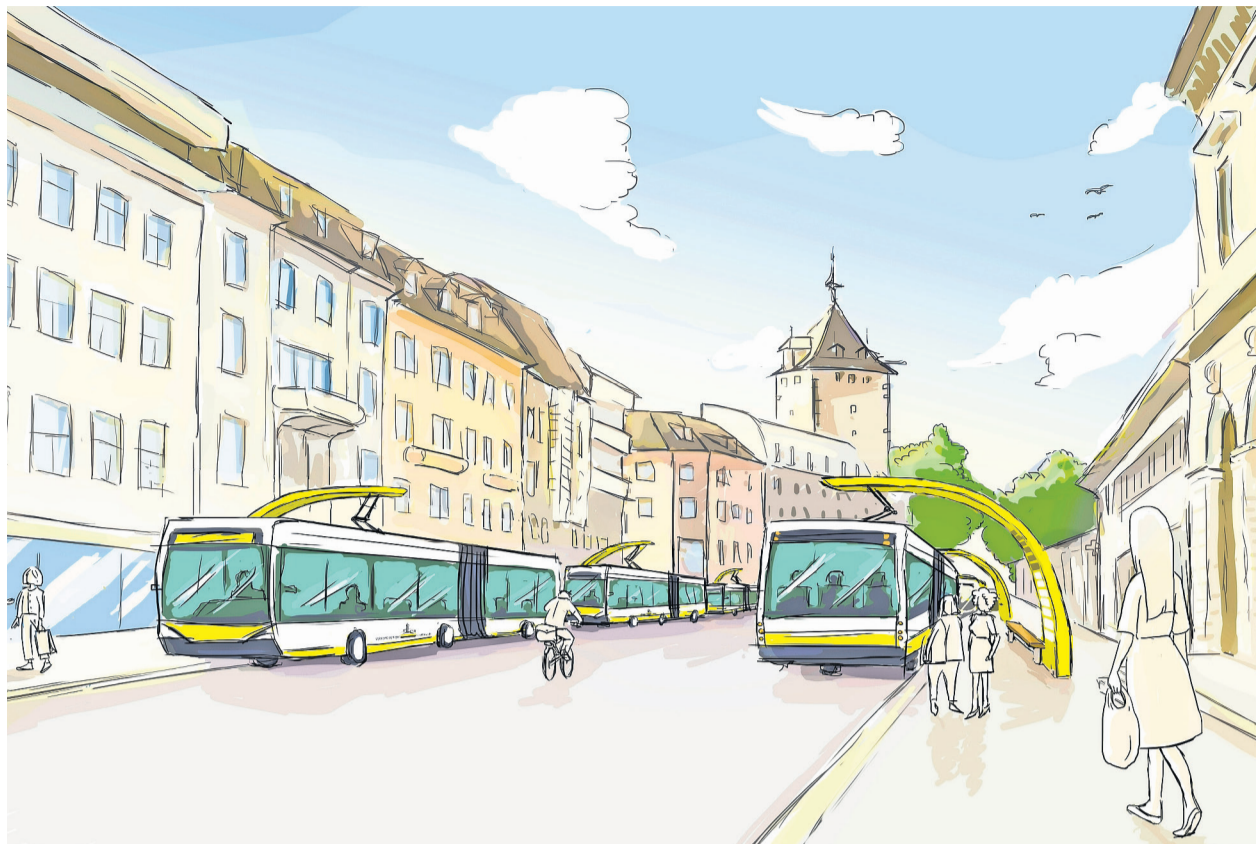
Die Elektrobusse mit Schnellladesystem sollen nachts im Depot und tagsüber während der Wartezeiten am Schaffhauser Bahnhof durch Ladebügel mit Strom versorgt werden. Bild Eclipse Studios
